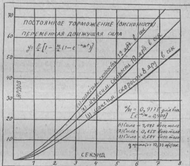
Рис. 4. Кривая времен — расстояний трех бегунов. Постоянная вязкость при переменной движущей силе.
